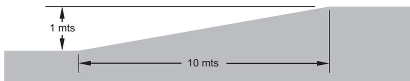
$$\text{Inclinação da Rampa} = \frac{1}{10}$$
