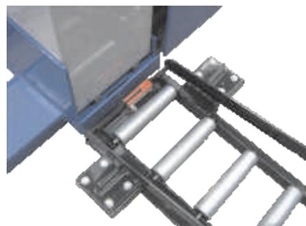
4 Posicionar o carro de troca de bateria alinhado à bateria;
